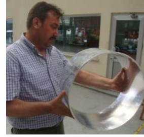
Figür 6: a) Ø430mm Çapında Boru Üretimi b) Pres Boyut Limitleri(Asaş Alüminyum 55MN)
