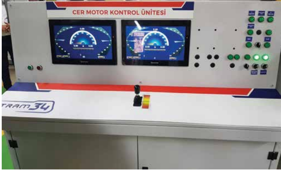
Şekil 3: TRAM34 Cer Motor Kontrol Ünitesi
